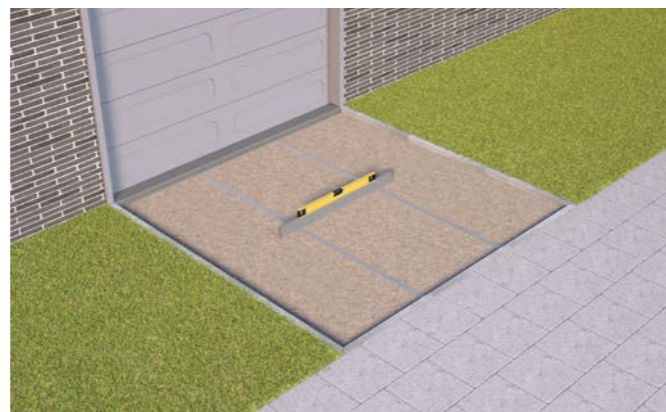
Fundering, straatlaag, nivelleren met paslatten en niveau diktes
